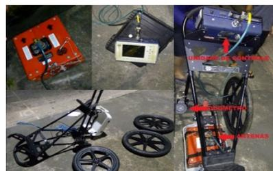
Figura 4 - Antenas, unidade de controle, carrinho e equipamento montado. / Fonte: autor.
